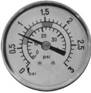
0,8 kg/cm 2 - 11,4 PSI: filitreleme sürecinin başındaki normal basınç
