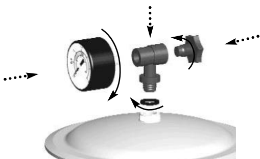
Montaje manómetro (con válvula lateral)
