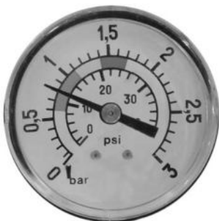
0,8 \text{ kg/cm}^2 - 11,4 PSI: Presión normal al iniciar un ciclo de filtración.
