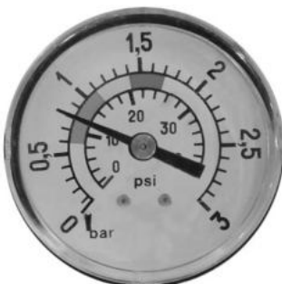
0,8 kg/cm 2 - 11,4 PSI: Normaldruck bei Beginn des Filtriervorganges.
