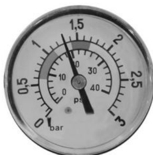
1,3 \text{ kg/cm}^2 - 18,5 PSI: Esta presión indica que es necesario proceder al LAVADO
